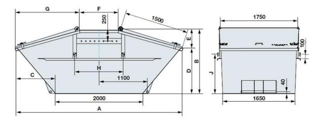
Unter Behälterhöhe 2000 mm H = 1100, J = 900Ab Behälterhöhe 2000 mm H = 1700, J = 1100
